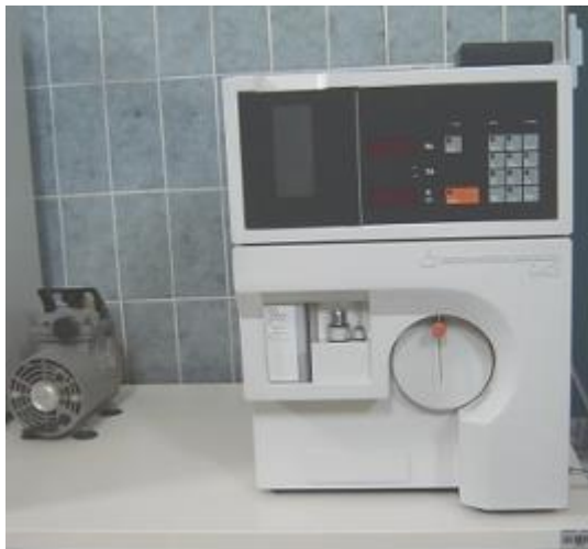
Slika 4 - 4 Plamenski fotometer z internim standardom za merjenje natrijevih in kalijevih ionov
