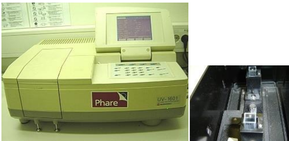
Slika 3 - 7 Izpopolnjeni dvožarkovni spektrometer in notranji del s kivetama.
