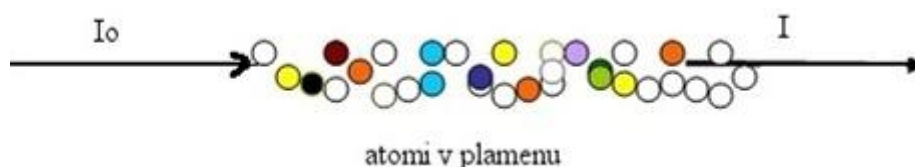
Slika 3 - 12 Prikaz absorpcije svetlobnega žarka na nevzbujenih atomih v plamenu
