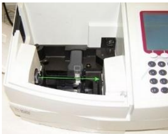
Slika 3 - 5 Vstavljiva kiveta v enožarkovnem spektrometru
